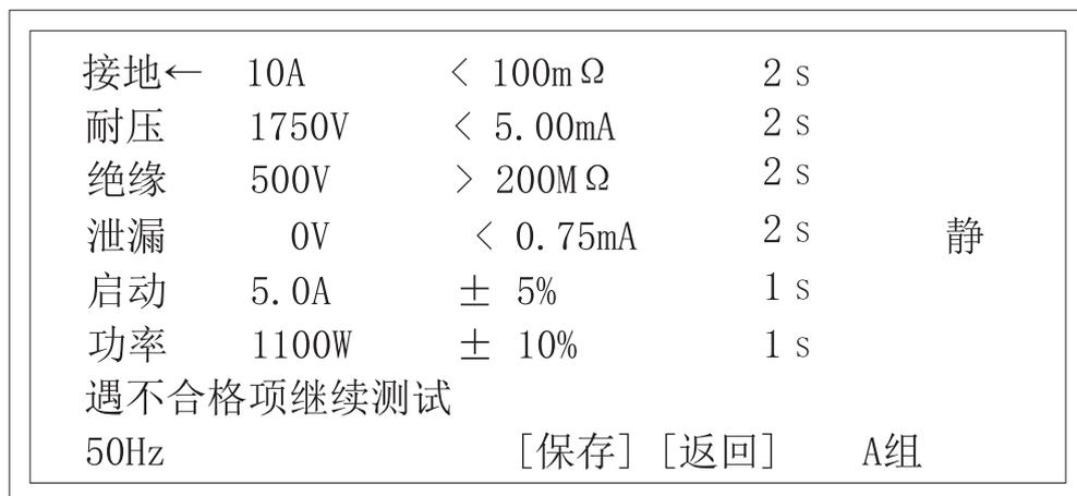
在每一行行首，按上移键或下移键可以循环选择“接地”、“绝缘”、“耐压”、“泄漏”、“功率”、“启动”等测试项和空行。
