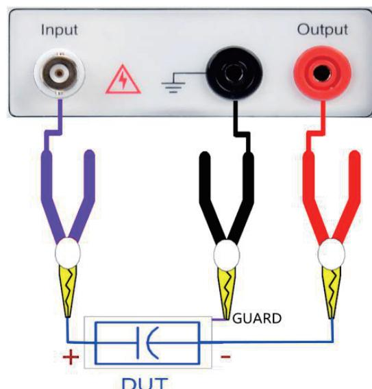
请勿向测量端子施加电压，否则可能会导致本仪器损坏。
