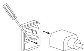
拔去电源线并使用螺丝刀取出保险丝座。如右图示：
