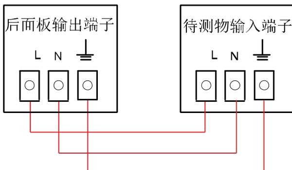
IT7322T/IT7322HT/IT7324T/IT7324HT/IT7326T/IT7326HT 的后面板输出端（卸下面板之后）相同。当作为单相电源输出时，具体连接如下图：
