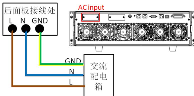
1. 按以上插图先将交流电源线一端连接到本电源后面板上的交流输入端子上。
