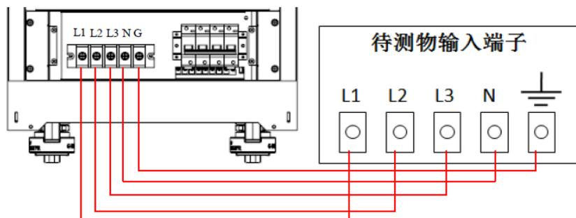
连接后面板输出的具体操作步骤如下：
