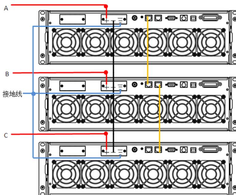
总线接口 (SYSTEM BUS): 总线接口需要用直连网线将三台设备相互连接, 如上图所示。
