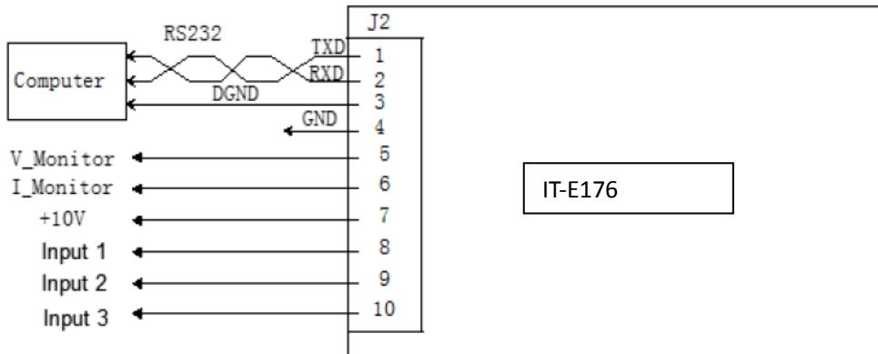
使用 RS-232 接口通讯时，需将 IT-E167 的引脚 1、引脚 2、引脚 3 与 PC 进行连接。引脚说明如下：
