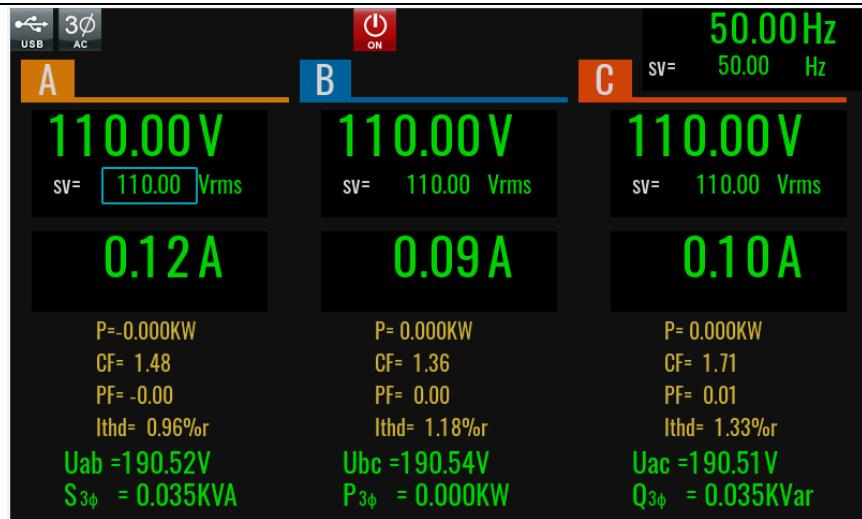
三相模式可以观察三相的全部参数，也可以单独设定或观察单相的数据。当按基本测量按键或向左滑动屏幕时，可以切换三相显示界面到单相显示界面，在单相显示界面中默认显示 A 相，点击 A、B、C 进行切换。
