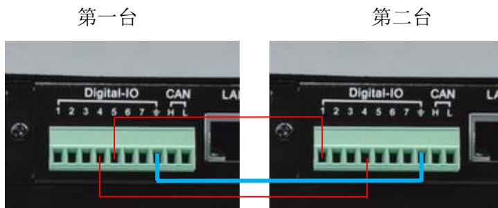
1. 连接第一台 IO-4 到 第二台 IO-4, 用来同步频率和相位
