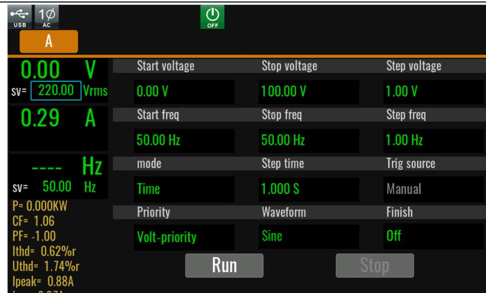
2. 在扫描界面中，完成对电压和频率相关参数值的设置。
