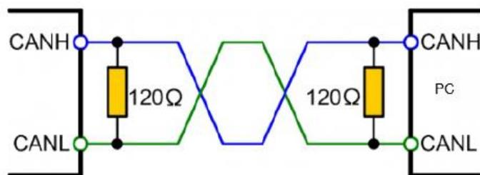
多台设备的连接示意图如下。
