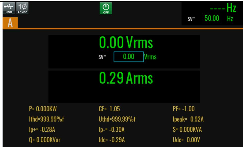
在 AC+DC 模式下，主界面可以设置交流电压，直流电压在 Config 菜单中设置。
