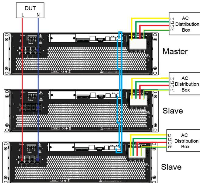
4. 将 3 台单机的 AC 输入电源线连接，分别接入配电箱。
