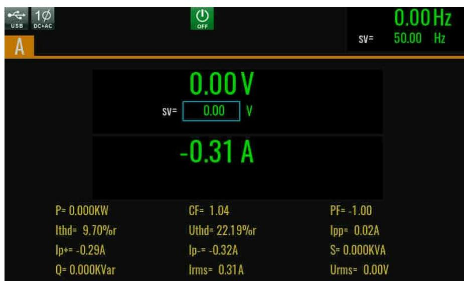
在 DC+AC 模式下，主界面可以设置直流电压，交流电压在 Config 菜单中设置。
