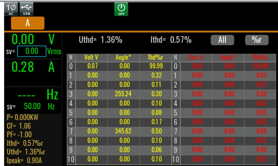
谐波次数列: List 可显示 0-50 次所有谐波信号的数据, 通过触摸上下移动显示未显示的行, 即未显示的单次谐波数据。
