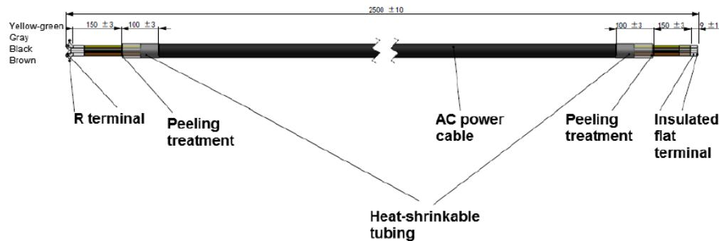
其中，黄绿色线为接地线，接入仪器后面板电源输入的 PE 端子，其余为火线，对应接入仪器后面板电源输入的 L1、L2、L3 端子。
