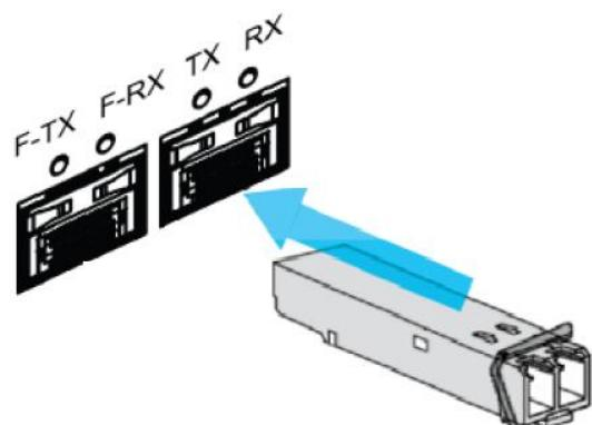
2. 将光纤线的插头插入到光纤模块中，听到咔哒声音表示插入到位。光纤线连接示意图如下：
