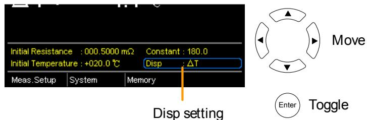
T 显示在待测物测量电阻下的推测温度
