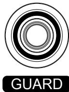
GUARD 端与大地具有相同电势，但不可替代。将 GUARD 端连接到测试线的电缆屏蔽层，有助于减少噪音
