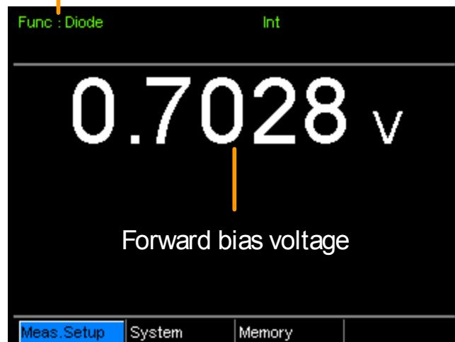
3. 连接测试线并 连接 Sense+, Source+ 至正极
