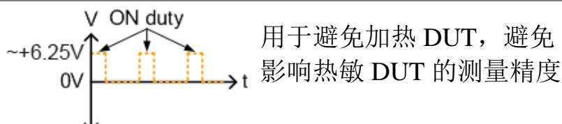
用于避免加热 DUT，避免影响热敏 DUT 的测量精度
