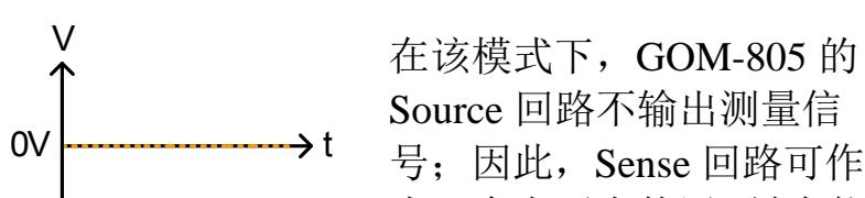
在该模式下，GOM-805 的 Source 回路不输出测量信号；因此，Sense 回路可作为一个电压表使用，最大能测量 +/-10mV 的热电 EMF。有利于测量热偶丝的 Vemf
