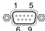
**PC – GOM RS-232C 连接** RS232C 采用直连方式，传输(TxD)和接收(RxD)线交叉
