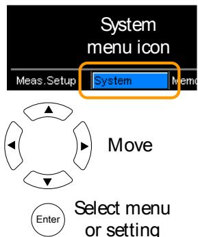
2. 显示高压保护菜单 使用方向键更改高压保护设置，然后按 Enter 按钮确认并生效。
