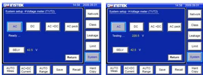
**面板操作** 触摸 **Meter**, 即会出现 Meter 测量界面。
