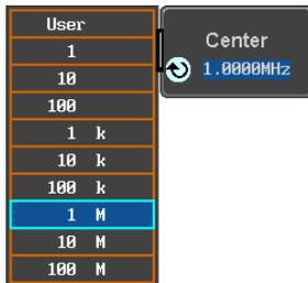
可变旋钮可用于进行选择。再按 *Center* 按钮; 可以使用可调旋钮以选定的步进分辨率为增量来设置频率。
