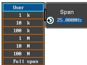
可调旋钮可用于选择。再按 *Span* 按钮;可以使用可调旋钮以选定的步进分辨率为增量来设置频率。
